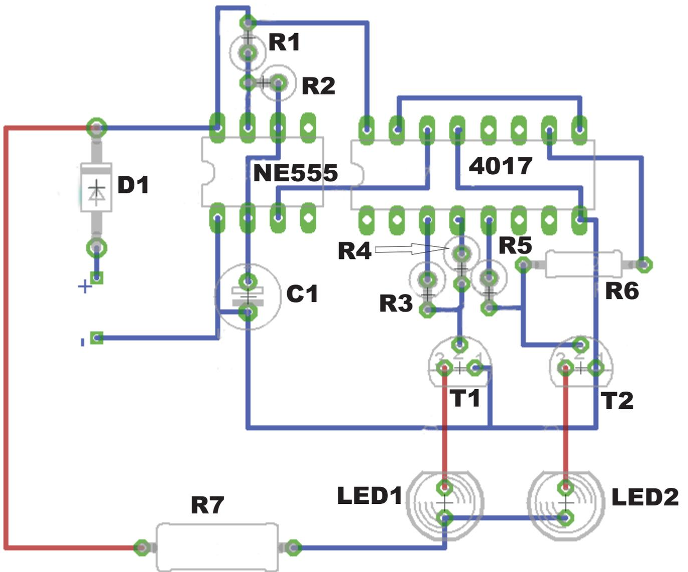
R7 und die LEDs sind über Kabel mit der Platine verbunden. Hier kann man auch mehrere Widerstände für die einzelnen LEDs verwenden. Die Anzahl der LEDs wird nur durch den Maximalstrom der Transistoren bzw. des Akkus begrenzt. Die Widerstände müssen dann entsprechend verändert werden.
